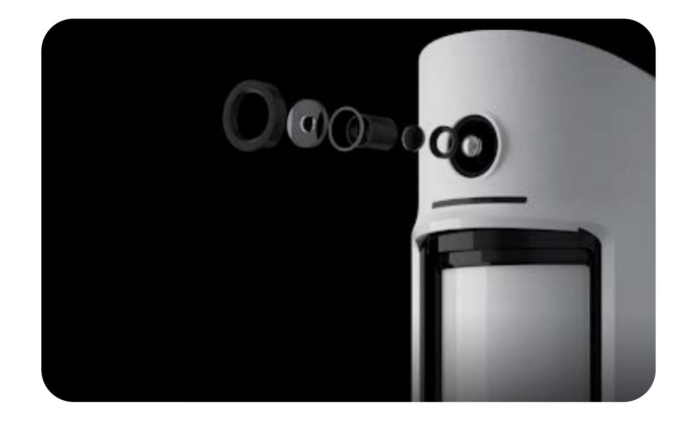
El MotionCam está equipado con una cámara integrada para mostrar la situación real en la instalación. Una cámara integrada se activa si el detector está armado y se detecta movimiento. Solo los usuarios con acceso al historial de eventos del hub y los empleados de la compañía de seguridad pueden ver las fotos. La arquitectura del software del detector no permite tomar una foto bajo demanda.
